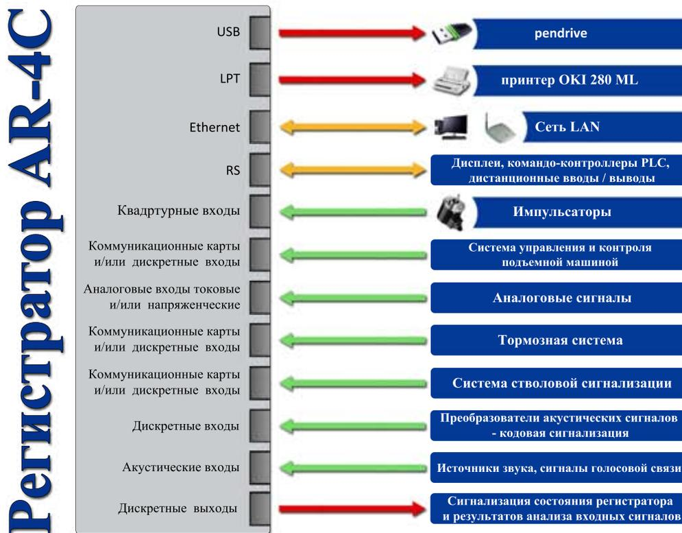
Рис. 2. Наглядный способ подключения регистратора AR-4с к цепям подъемной машины.
